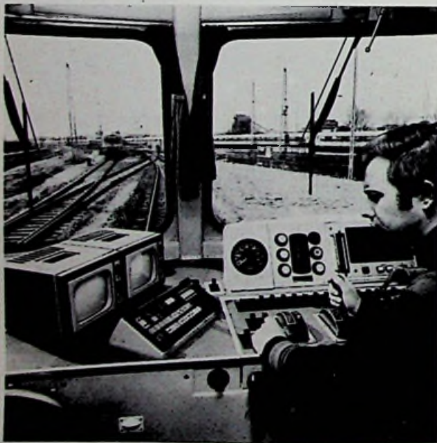
stuurcabine van een Duitse regiotrein met TV-monitor voor het overzien van het perron
